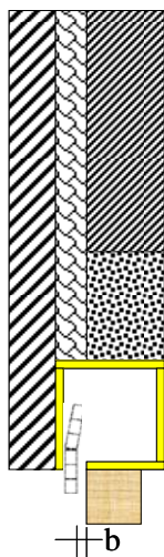
Figure 33 – Ventilation du coffre de volet
